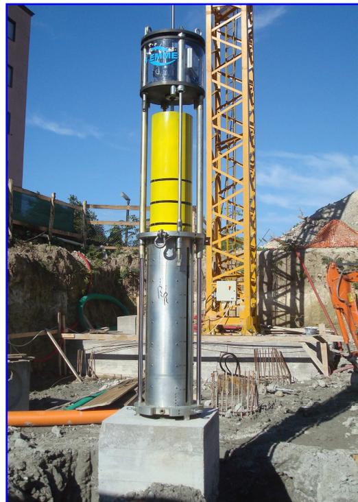
ulteriormente l'altezza di caduta in quanto la maggiore velocità di impatto rende difficile la corretta lettura dei valori di accelerazione sulla testa del palo.
