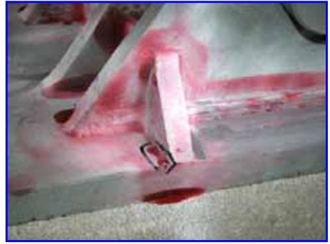
*Controllo con liquidi penetranti visibili su giunti saldati*
