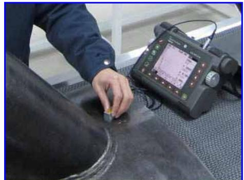
Controlli di giunti saldati con sonde angolate
